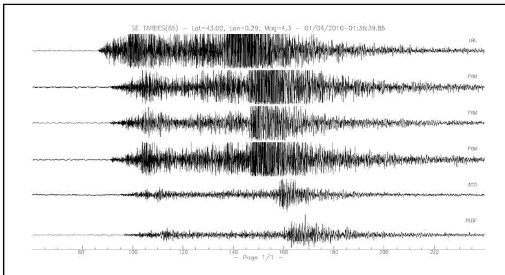
Fig. 4 : Exemple d'enregistrements accélérométriques du séisme du 1<sup>er</sup> Avril 2010 sur les stations du RAP.
